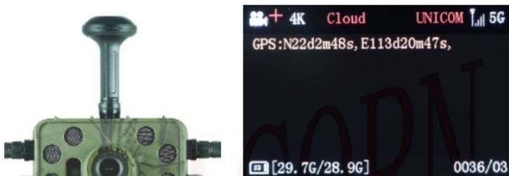
**注意：**GPS 需要在室外看到天空的地方才能接收到卫星信号，树林密集的地方或在建筑物下也会严重影响 GPS 接收卫星信号。为保障相机 GPS 功能的正常使用，请将相机安装在户外露天的地方，并尽量避免相机上方有物体遮挡。
